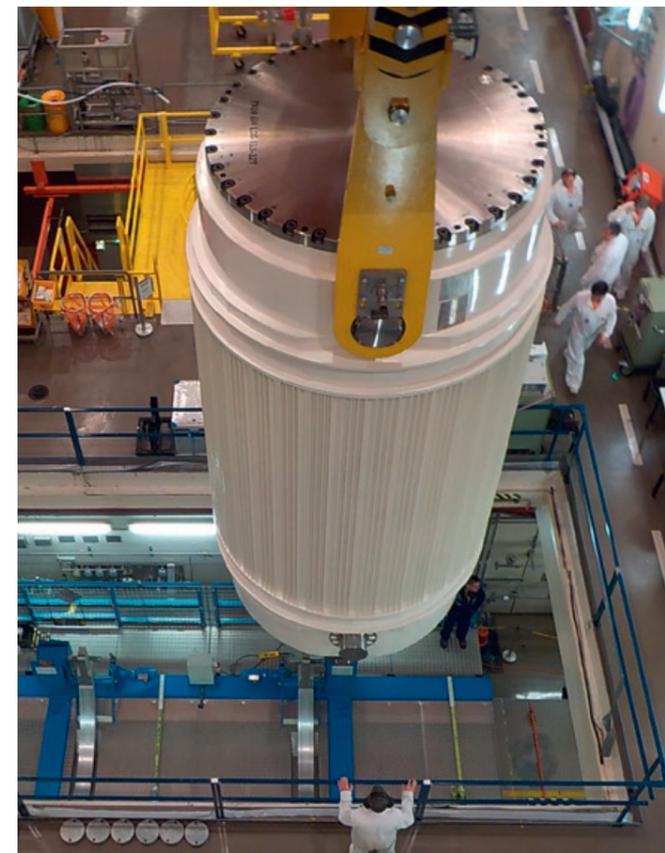
In extrem soliden Behältern werden verbrauchte Brennelemente ins ZWILAG transportiert. Sie lagern dort bis zur Entsorgung im geologischen Tiefenlager.
